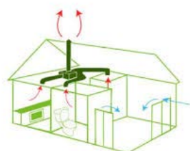
Instalación de ventilación
